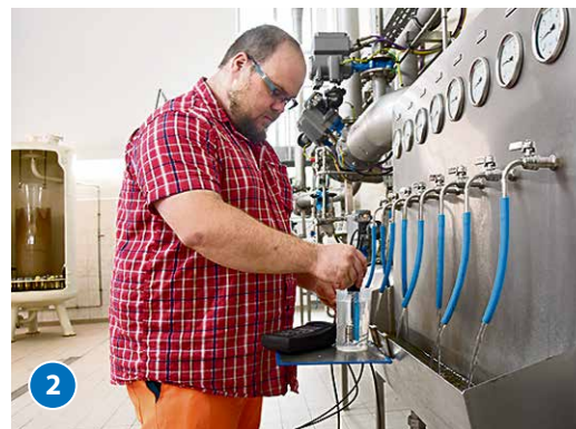
Die Wasserprüfstation – Kontrolle von Anfang an: Wasserwerker Alexander Becker misst an der Wasserprüfstation direkt nach der Förderung den Sauerstoffgehalt und den pH-Wert des Rohwassers. Er entnimmt dort auch regelmäßige Proben für das Labor. Veränderungen der Wasserbeschaffenheit lassen sich so frühzeitig erkennen.
