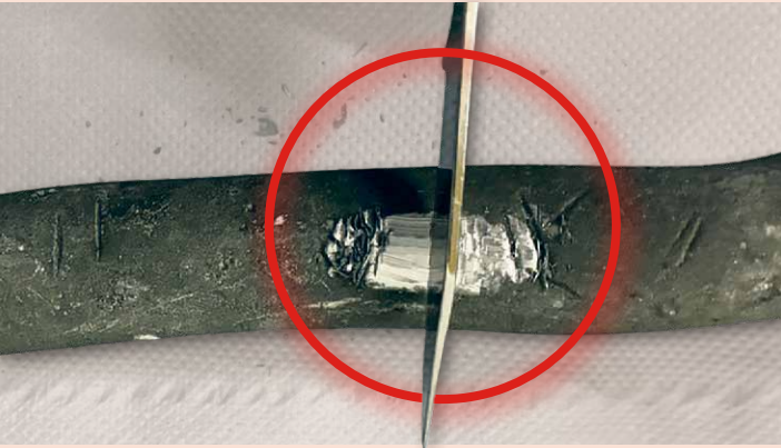
Hausbesitzer erkennen Bleirohre am weichen, nicht magnetischen Material. Wer mit einem Messer am Rohr kratzt, erhält eine markante, blanke Stelle.
